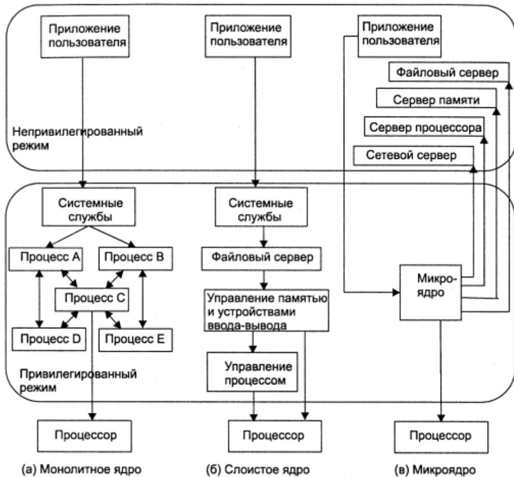
Рис. 7.5. Классификация по типу архитектуры ядра
