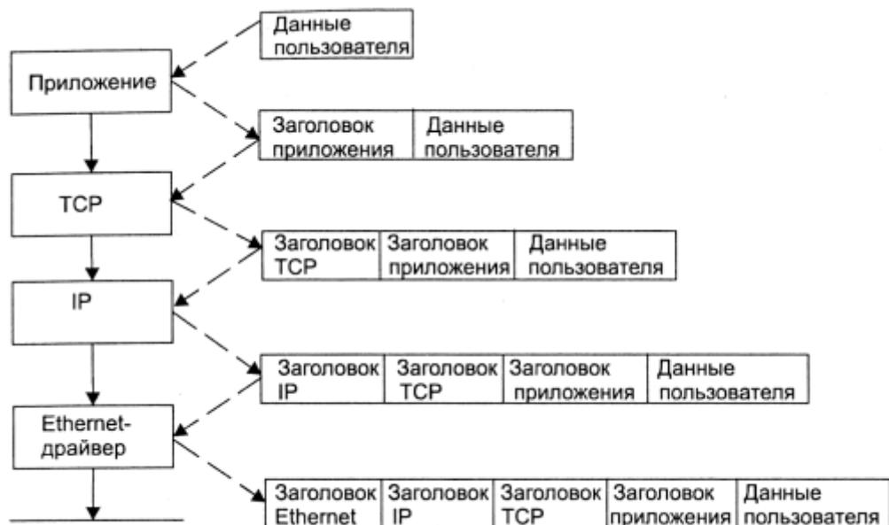
Рис. 7.11. Обмен данными в соответствии с протоколами стека TCP/IP
