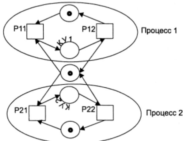
**Рис. 7.9.** Моделирование взаимного исключения с помощью сети Петри
